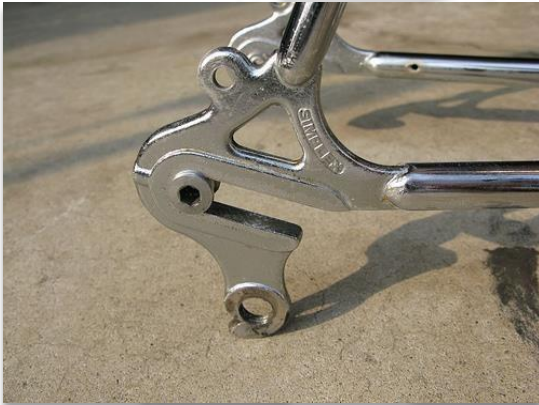
Marco antiguo con punteras del eje trasero.
