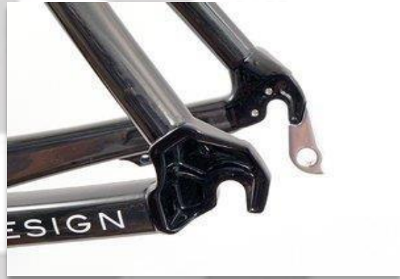
Marco reciente con punteras del eje trasero.
