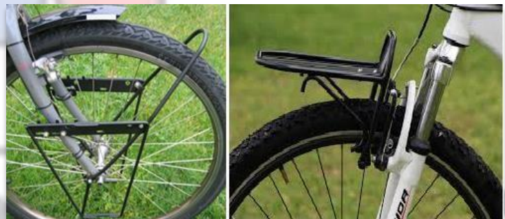
Parrillas frontales: horquilla sin (izquierda) y con (derecha) suspensión
